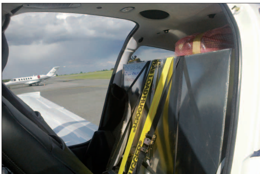
Přídavná nádrž na 400 litrů paliva umístěná v zadním prostoru Cirrusu. Sympatický pilot James Creamer, který s Cirrusem přelétl
